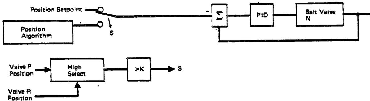
Figure IV.G.10. Salt Bypass Valve Control
