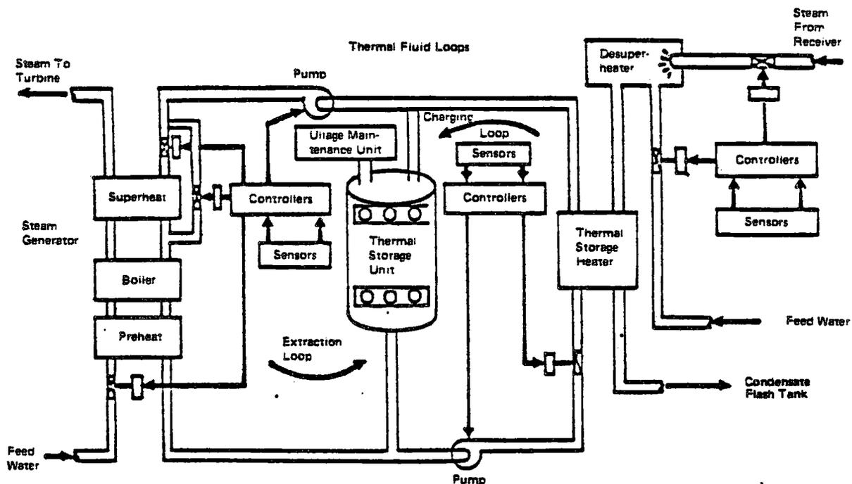
Figure III.B.12. Thermal Storage Schematic
