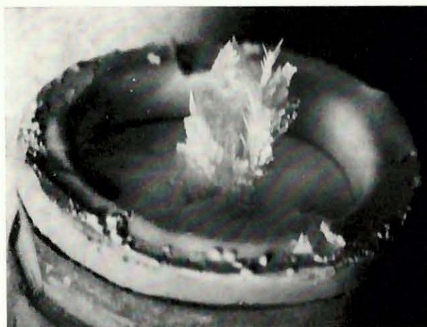
FIG. 5. — Aiguilles de rutile obtenues à 1300° C sur un substrat d'alumine ( G \times 3 ).
